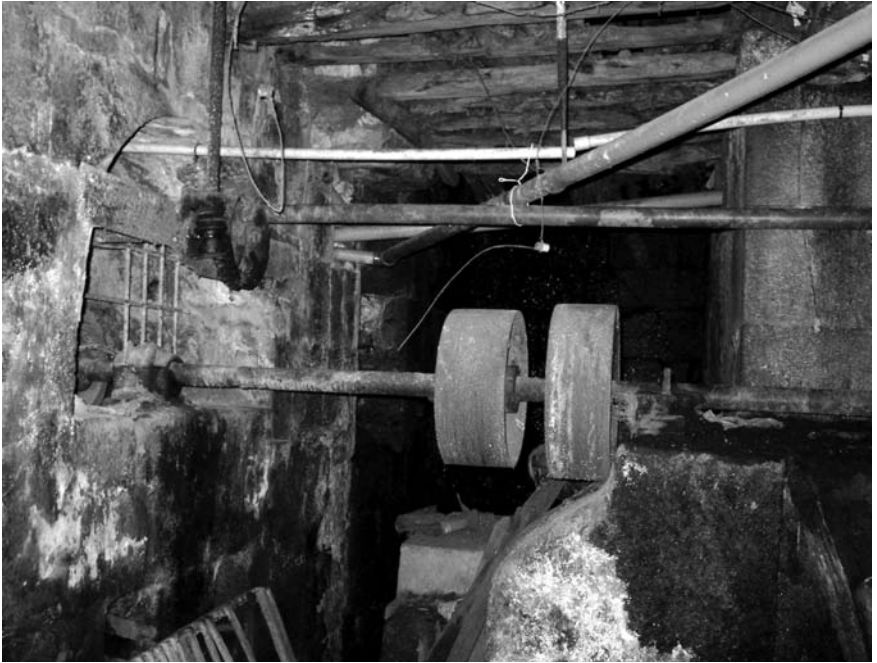
Restos dunha transmisión –á esquerda quedaba a turbina.
